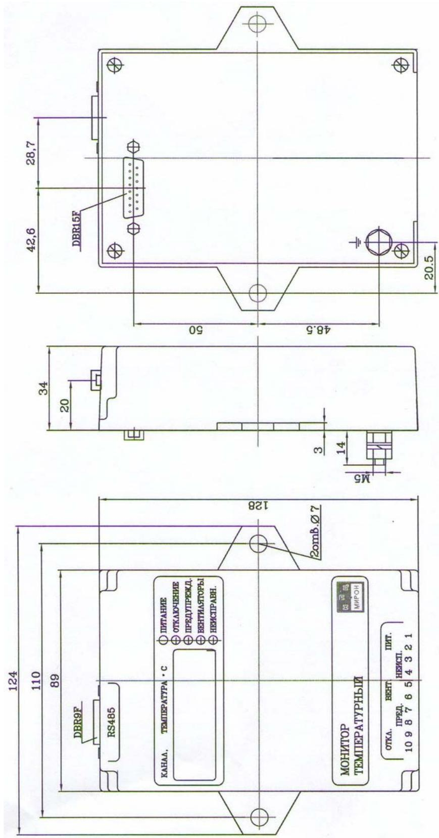
Рисунок 1 – Внешний вид и габаритные размеры прибора
